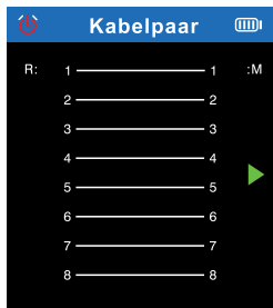
Oberfläche von Kabelpaar
